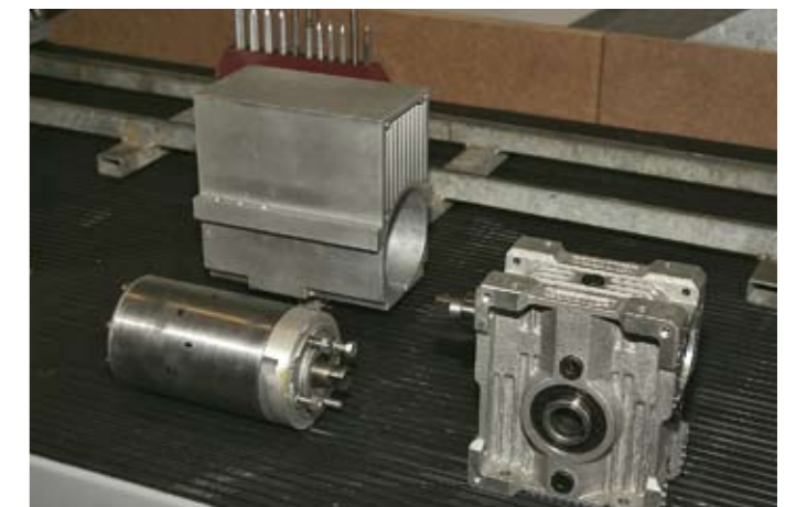
Motor (l.) und Getriebe (r.), dahinter das erodierte Motor-Kühllement.
