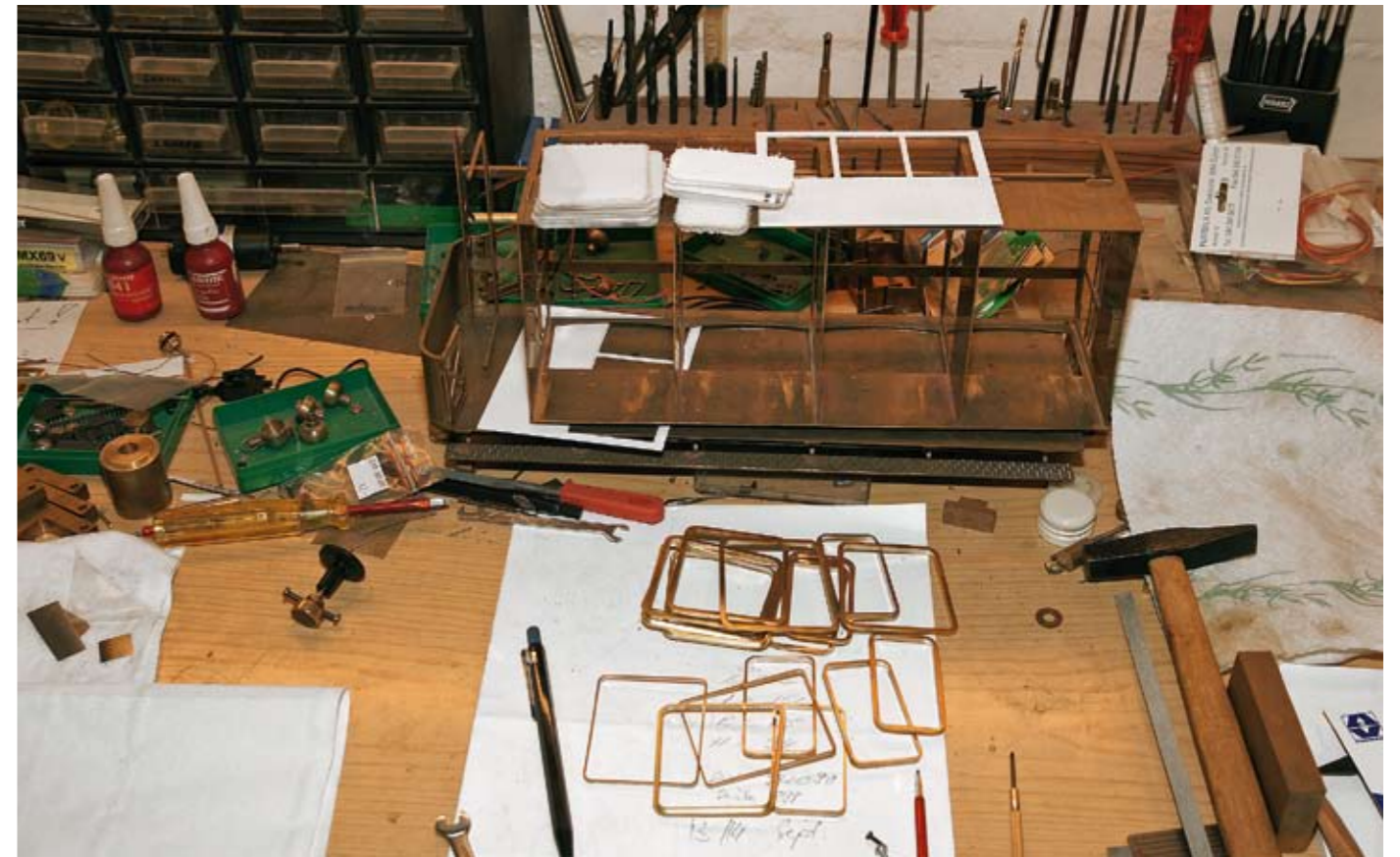
Gefräste Fenster und Fensterrahmen liegen neben anderen sich in Arbeit befindenden Projekten auf Walter Bernets Arbeitstisch.
